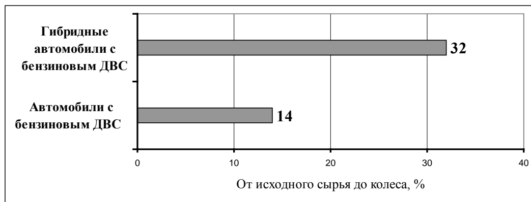
Рисунок 3.4 – Сравнение энергетической эффективности гибридных автомобилей с бензиновым ДВС и автомобилей с бензиновым ДВС [16]
