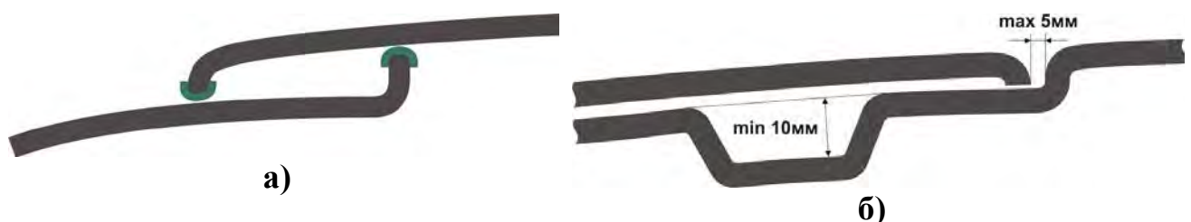
Рисунок 4.77 – Схемы приемов защиты кузова от попадания осадков при стыке между стационарно закрепленной деталью и съемной или откидной панелью
