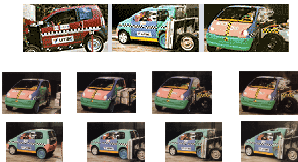
Рисунок 2.6 – Тесты пассивной безопасности модели МТС фирмы « AIXAM-MEGA »: (иллюстрации фирмы-производителя)
