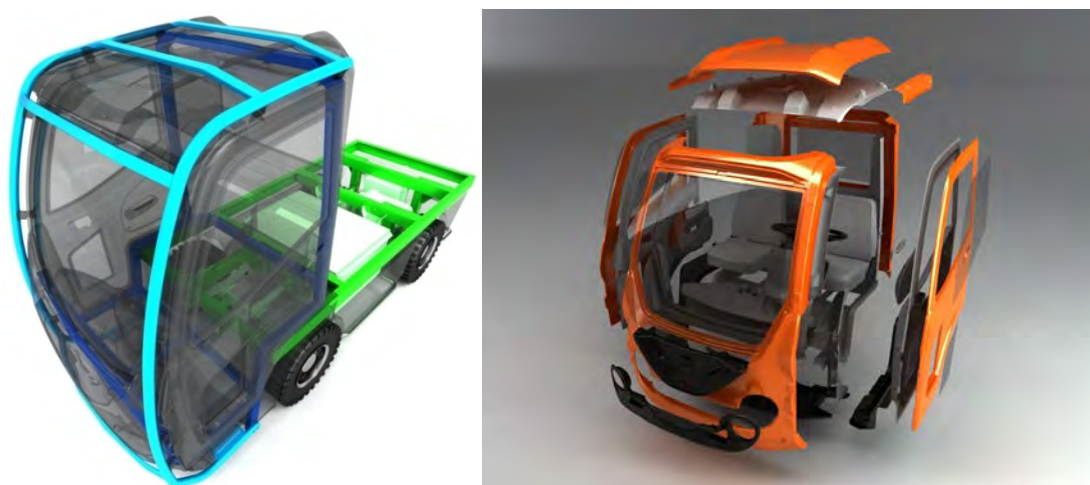
Рисунок 5.5– Рентген-схема МТС и взрыв-схема полимерных панелей кабины
